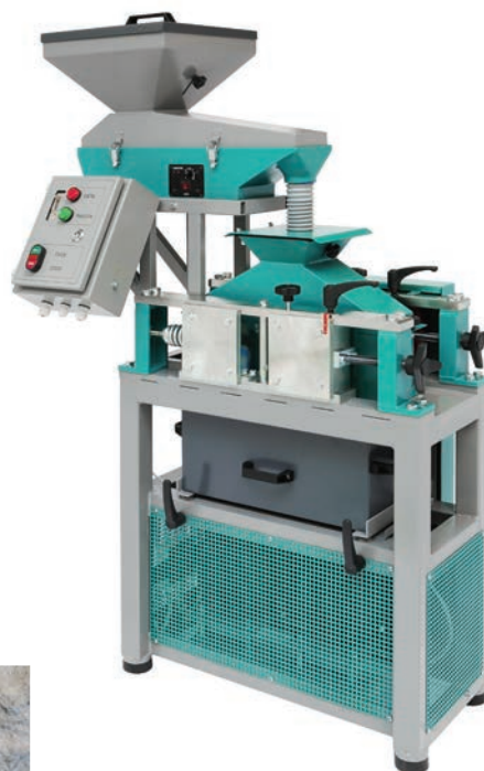
Установка на базе ДВГ 200x125 с Питателем ПГ 1 и Пультом МАПУЗ-05
