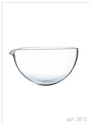
Универсальная химико-лабораторная посуда. Чашки выпарные имеют округлую форму и большой диаметр горловины. Доступны в исполнении с носиком и без носика. Благодаря равномерной стенке чашки возможна работа в высоком диапазоне температур.
