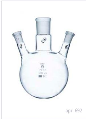
Круглодонная колба с тремя горловинами, расположенными под углом, со стандартным шлифом горловин для герметичного присоединения дополнительных приборов, таких как термометры, капельные воронки, мешалки и др. Оптимальный баланс стойкости к тепловому шоку и прочности гарантирует долгий срок службы изделий.
