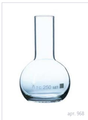
Устойчивое плоское дно и равномерно утолщенные стенки делают колбу идеальной для нагревания и позволяет использовать это изделие непосредственно на нагревательной плитке и без дополнительной фиксации. Оптимальный баланс стойкости к тепловому шоку и прочности гарантирует долгий срок службы изделий.
