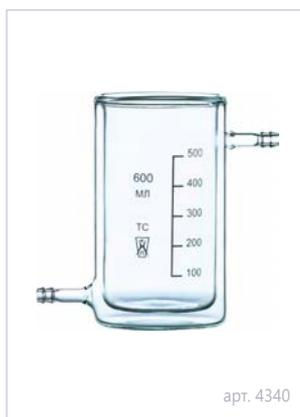
Идеально подходят для бережного и равномерного нагрева либо охлаждения жидкостей. Стакан оснащен рубашкой с оливами под гибкий шланг внутреннего диаметром 10 мм. Типичное применение: титрование, разложение энзимами, реакции органического синтеза.
