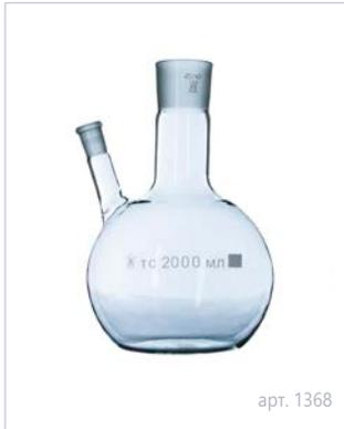
Плоскодонная колба с двумя горловинами, расположенными под углом, со стандартным шлифом горловин для герметичного присоединения дополнительных приборов, таких как термометры, капельные воронки, мешалки и др. Плоское основание колбы позволяет нагревать изделие в том числе на нагревательной плитке. Оптимальный баланс стойкости к тепловому шоку и прочности гарантирует долгий срок службы изделий.
