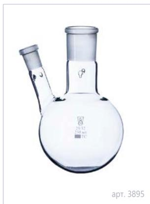
Круглодонная колба с двумя горловинами, расположенными под углом, со стандартным шлифом горловин для герметичного присоединения дополнительных приборов, таких как термометры, капельные воронки, мешалки и др. Оптимальный баланс стойкости к тепловому шоку и прочности гарантирует долгий срок службы изделий.
