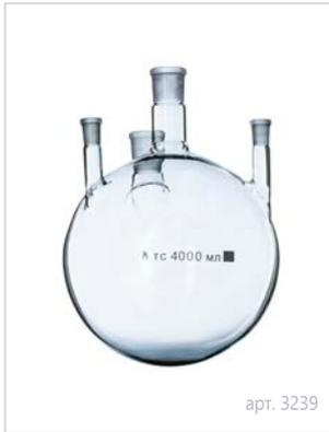
Круглодонная колба с четырьмя параллельными горловинами со стандартными шлифами для герметичного присоединения дополнительных приборов, таких как термометры, капельные воронки, мешалки и др. Оптимальный баланс стойкости к тепловому шоку и прочности гарантирует долгий срок службы изделий.
