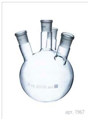
Круглодонная колба с четырьмя горловинами, расположенными под углом со стандартным шлифом горловин для герметичного присоединения дополнительных приборов, таких как термометры, капельные воронки, мешалки и др. Оптимальный баланс стойкости к тепловому шоку и прочности гарантирует долгий срок службы изделий. Колбы изготовлены из термически и химически стойкого боросиликатного стекла 3.3.
