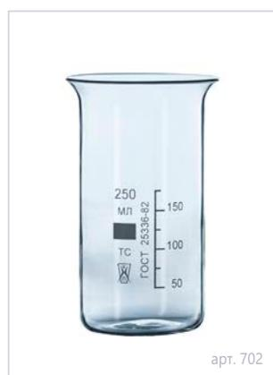
Высокий лабораторный стакан предназначен для фильтрования, выпаривания и приготовления растворов. Благодаря утолщенной равномерной стенке изделие идеально подходит для нагревания даже при очень высоких температурах. Стакан выпускается в исполнении с носиком и без, на изделие нанесены легко читаемая градуировка и окошко для маркировки из огнеупорной белой керамической эмали. Объем указан приблизительно.
