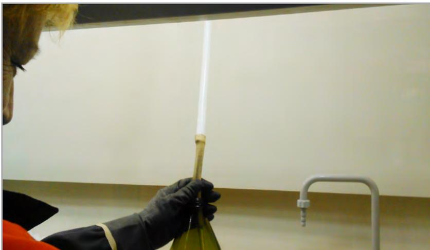
Расфасовку более опасных жидкостей проводят в вытяжном шкафу.
