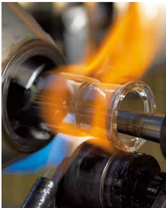
Produktion von Schliff-Rohlingen aus DURAN®-Rohr auf vollautomatischen Glasverformungsmaschinen.
