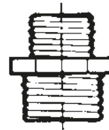
Штуцер редукционный с внешней резьбой.
