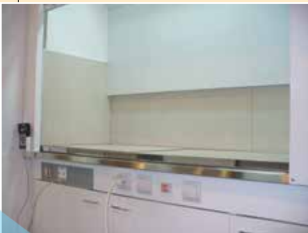
Вытяжная камера шкафа 1500 ШВМк-ХС-прн: стеклопластиковый купол, разделение потоков – пластик, опция – обкладка керамикой
